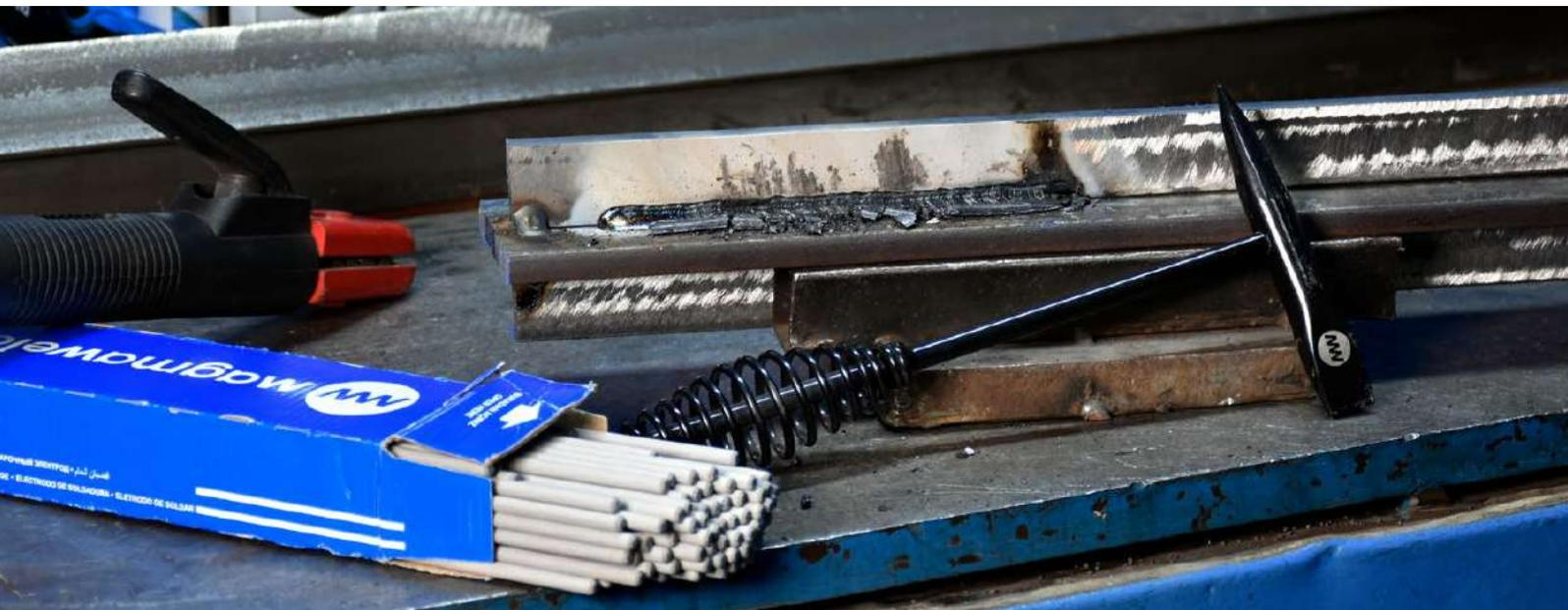
Los martillos de soldadura Magmaweld son herramientas de taller ideales para eliminar fácilmente la escoria formada después de la soldadura, disponibles en versiones con mango en espiral de **300 g** y **500 g**, así como en opción con mango plástico de **500 g**.
