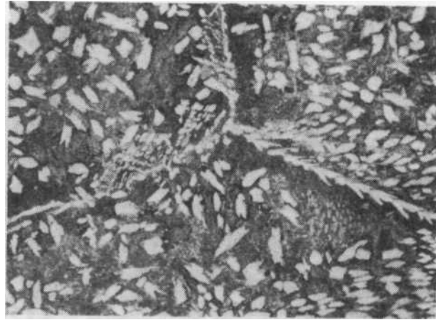
Şekil: 73 — Cu-Al 90-10, dökümden çıktığı gibi (ko-kil dökümü) \alpha katı eriyikinin beyaz kristalleri ve \alpha - \gamma_2 ötektoidi (koyu), \alpha katı eriyikinden şerit, katılaşmanın çabuk oluşundan ileri gelmiştir. X 100 Demir perki, ile dağl.
