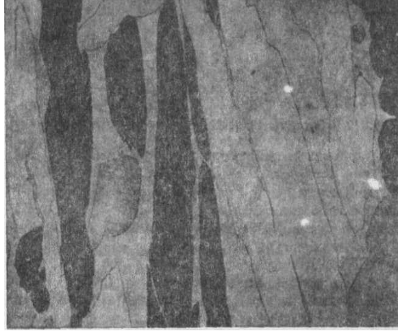
Şekil: 64 — Muntz metal, sıcak yoęurulmuş <math>\alpha</math> katı eriyiki-beyaz ve bir miktar <math>\beta</math> katı eriyiki-koyu) X 100.
