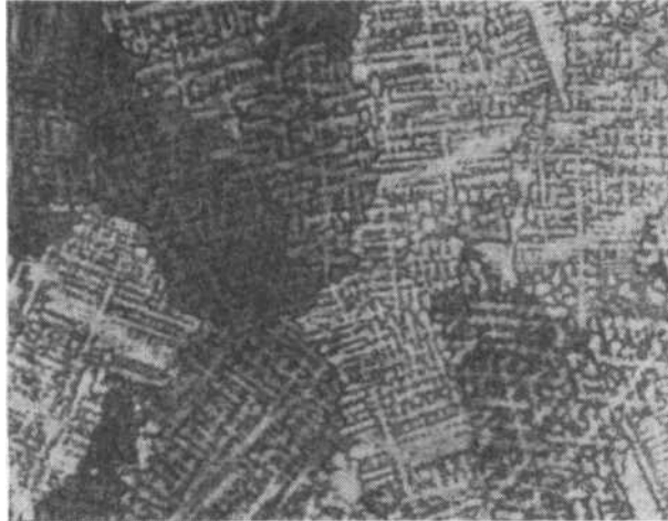
Şekil: 67 — Pirinç 67-33, dökümden çıktığı gibi. Ho-mogen olmayan dendritik \alpha katı eriyiki. X 50. Demir perklorürü ile dađl.
