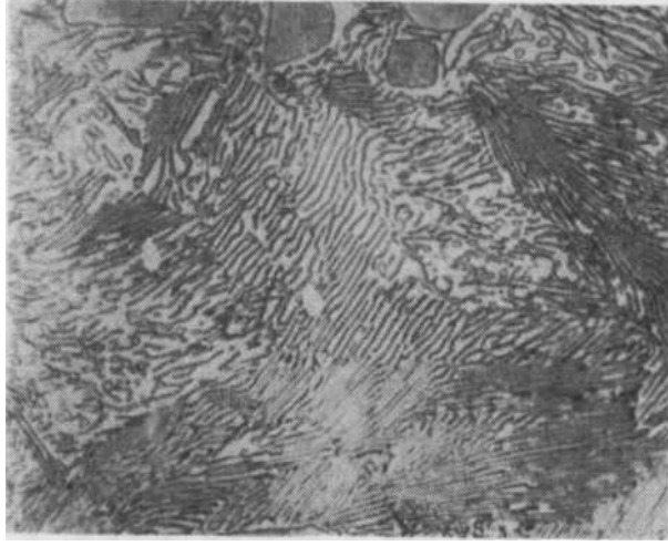
Şekil: 74 — Cu-Al 90-10, 550°C'ta tavlama, \alpha - \gamma_2 ötektoidinin perlit tipinde lameller yapısı. X 500. Demir perki, dağlama.
