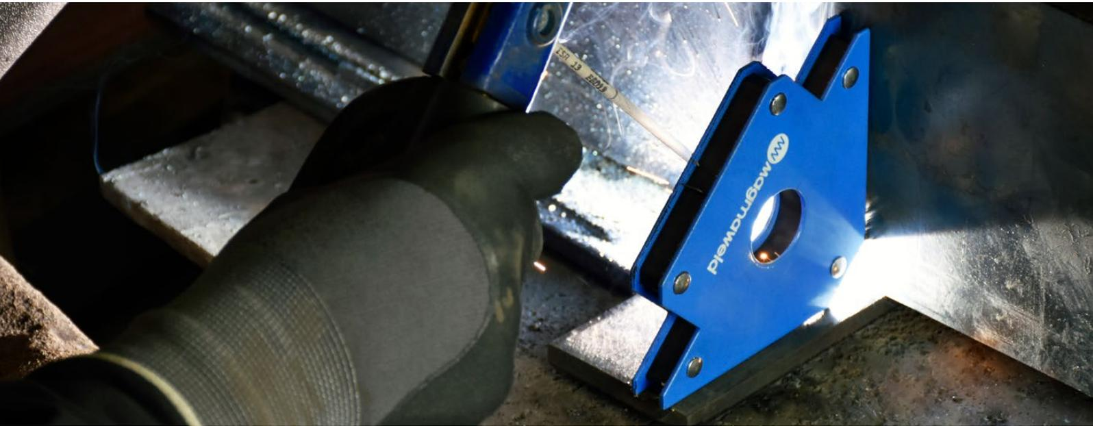
Die magnetischen Gehrungen von Magmaweld sind in den Größen **11 kg / 22 kg** mit den geometrischen Formen **AT** und **AX** erhältlich und helfen Ihnen bei Schweißanwendungen, die Maße ohne Interpunktion zu fixieren.
