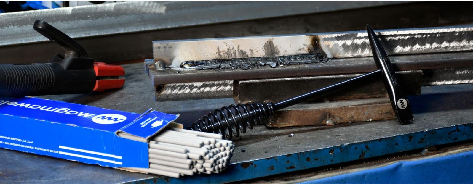
Die Magmaweld-Schweißhämmer mit **300 g** und **500 g** Spiralstiel und **500 g** geradem Stiel sind ein ideales Werkstattwerkzeug, mit dem Sie die nach dem Schweißen entstandenen Formen bequem entfernen können.
