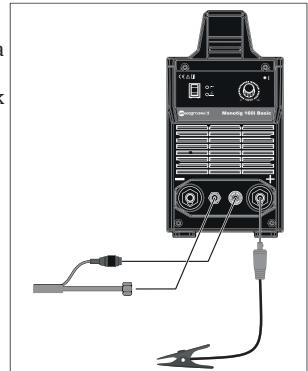
Şekil 4 : TIG Kaynak Bağlantıları
