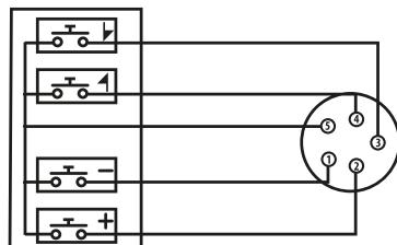
(2) Ориентиры указаны с учетом направления пайки хвостовой части кабельного соединения.
