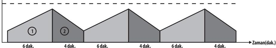
EN 60974-1 standardında da tanımladığı üzere çalışma çevrim oranı 10 dakikalık bir zaman periyodu içerir. Örneğin olarak %60'da 250A olarak belirtilen bir makinede 250A'de çalışılmak isteniyorsa, makine 10 dakikalık zaman periyodunu ilk 6 dakikasında hiç durmadan kaynak yapabilir (1 bölgisi). Ancak bunu takip eden 4 dakika makine soğuması için boşta bekletilmelidir (2 bölgisi).
