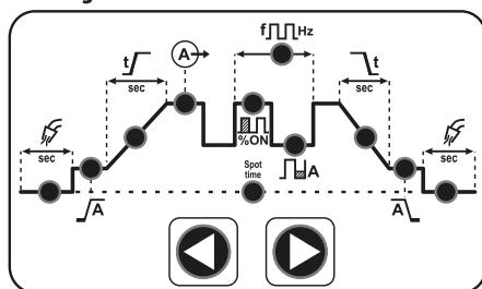
Tuşlar yardımıyla TIG eğrisindeki parametreler arasında dolaşabilirsınız. Hangi parametre seçili ise o parametreye ait led yanacaktır.
