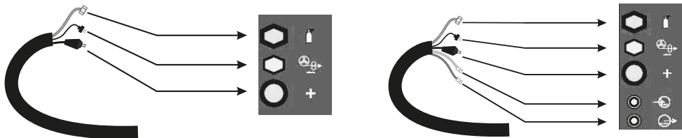
Рисунок 4 : Соединения механизма подачи проволоки с длинным промежуточным пакетом
